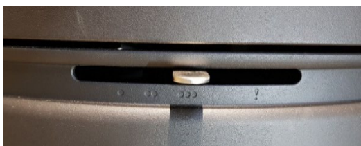
Figur 4 - Fuld sekundær luft
